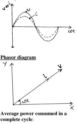
$$\langle \mathbf{P} \rangle = V_{rms} I_{rms}$$
