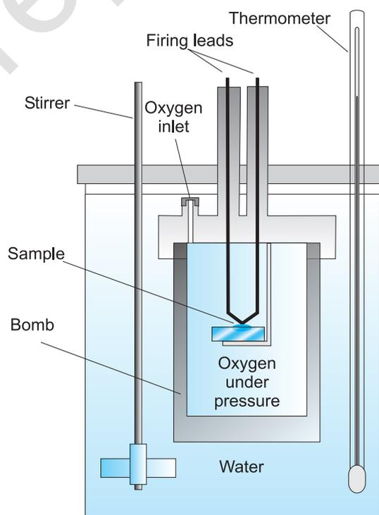
**Fig. 6.7** Bomb calorimeter
