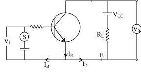
$V_{CE} = V_{CC} - I_C R_L$
