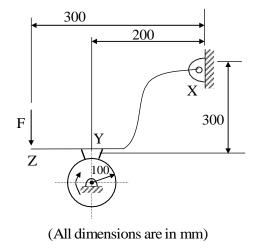
$$(R_{N} \times 200) - (\mu R_{N} \times 300) - (F \times 300) = 0$$
